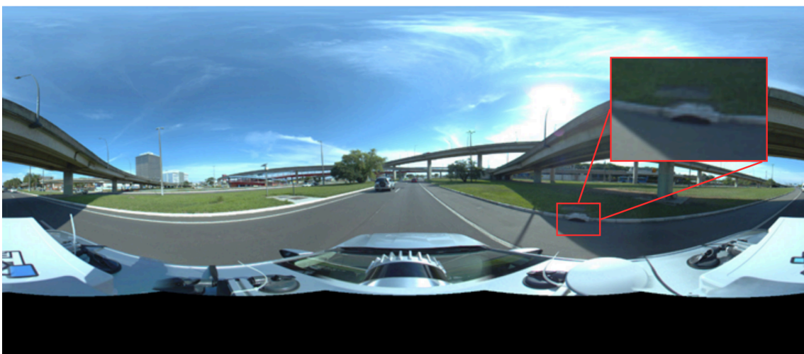
Figura 2 - Identificação de bocas de lobo a partir da utilização do Pix 360.
